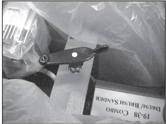
Fig. 4A Install knob
